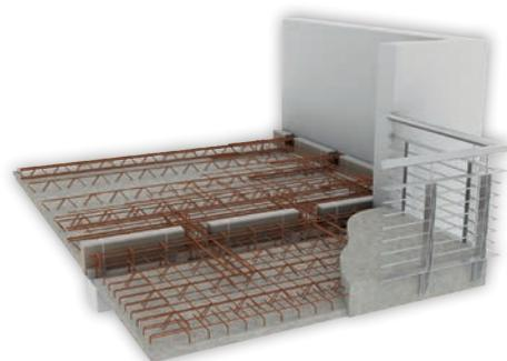
Pour les chantiers situés en zones sismiques 3 et 4, le Bureau d'Etudes Rector réalise le dimensionnement et la vérification des nervures sous effort sismique par modélisation aux éléments finis.
