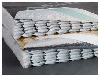
Solution haute performance 3 en 1, Triso-Toiture assure une isolation très efficace contre le froid en hiver grâce à une résistance thermique très élevée (R>6,20 m².K/W), mais aussi contre la chaleur, en été, grâce aux films réflecteurs renvoyant jusqu'à 95% des rayonnements infrarouges.
