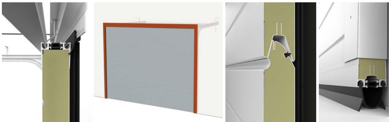
**Le Pack Isolation** améliore significativement les performances de la porte sectionnelle **MIAMI**. Grâce à des profils haut et bas à rupture de pont thermique qui équipent son tablier, à une structure doublée d'un joint mousse polyuréthane sur toute sa surface, les transferts thermiques entre l'extérieur et l'intérieur du garage sont fortement réduits permettant ainsi d'améliorer les performances thermiques de la porte de l'ordre de 20%.
