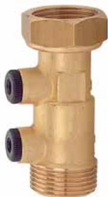
Grâce à un système exclusif de guidage par tige fendue qui élimine les jeux et au profil hydraulique optimal du clapet qui permet une pénétration idéale du fluide, les vibrations, et dès lors tout bruit qui en découle, sont supprimées. En assurant ce guidage sans jeux, les dépôts de calcaire sont également évités, garantissant ainsi un fonctionnement irréprochable et silencieux pendant des années.
