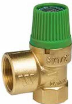
Destinée à protéger les installations à panneaux solaires conformément à la norme DIN 4757, la soupape de sécurité solaire de Watts évite une montée en pression excessive du circuit. Certifiée TÜV Solar, elle se compose d'un corps et couvre ressort en laiton et d'un bouton de manœuvre en résine renforcée résistante aux rayons U.V. A tarage fixe de 3,5 à 10 bar, sa membrane et son siège résistent à une température maximale d'utilisation de 160°C.
