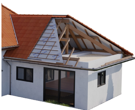
Isolation des combles perdus
